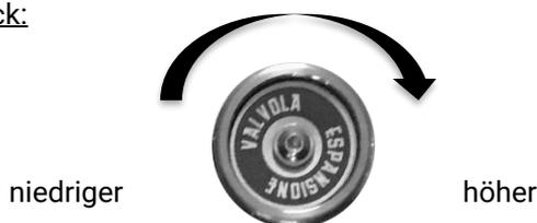
Durch Drehen des Griffs gegen den Uhrzeigersinn wird der Brühdruck niedriger, durch Drehen im Uhrzeigersinn höher.
